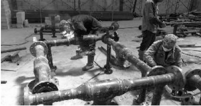
Gambar 76. Contoh Produk Pengelasan Pipa (Sumber: Simpati Welding Group).
