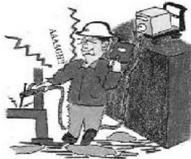
Gambar 40. Kabel Mengelupas dan Terkena Air.
